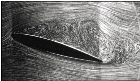
Décollement de la couche limite à l'approche du décrochage
