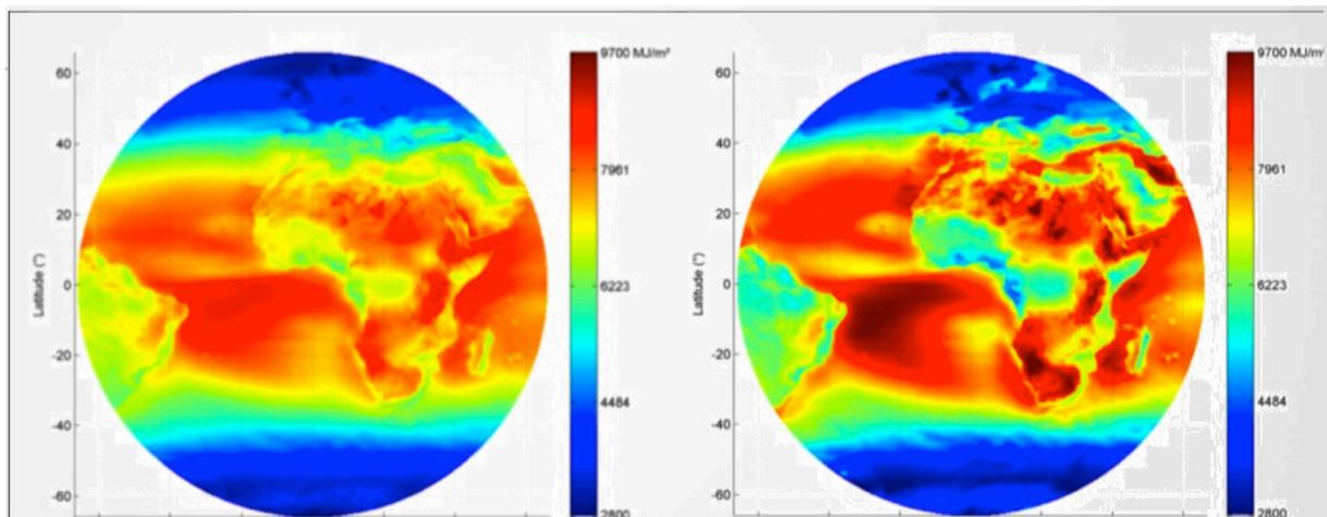
*Moyenne sur 2004-2010 de l'irradiation annuelle globale horizontale (gauche) et directe en incidence normale (droite) issue de la base de données HelioClim-3 (méthode Heliosat-2) créées par MINES [ParisTech \(www.soda-is.com\)](http://www.soda-is.com)*
