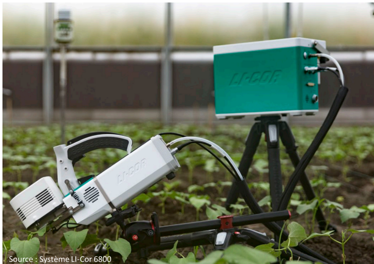
Chambre de mesure de la photosynthèse et de la transpiration
